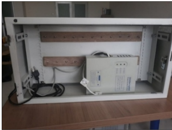
ภาพที่ 3 ตู้เก็บลูกกุญแจระบบสแกนลายนิ้วมือแล้วเสร็จ (ด้านหลัง)
