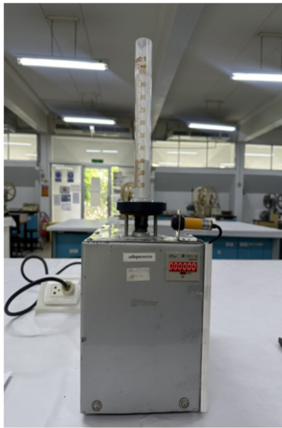
การวัดความหนาแน่นของผงยาด้วยเครื่องที่ได้ประดิษฐ์ขึ้น
