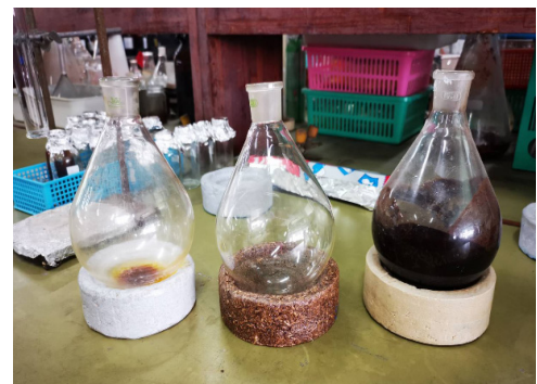
ภาพที่ 3 การใช้ฐานรองเครื่องแก้วกันกลมจากกระดาษ กากพีช และผงซิลิกาเจล ในห้องปฏิบัติการ
